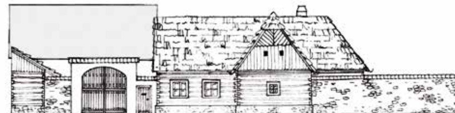
2 varianty možných uličních pohledů na rekonstruovanou fasádu stavení z období do konce 19. století s doškovou střechou.
